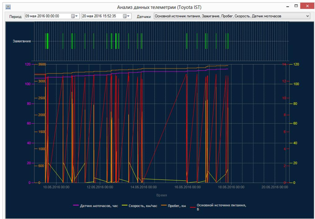
Рис. 6.7. Окно *Анализ данных телеметрии*
