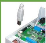
4. Подключите контроллер к компьютеру используя USB-кабель из комплекта поставки.
