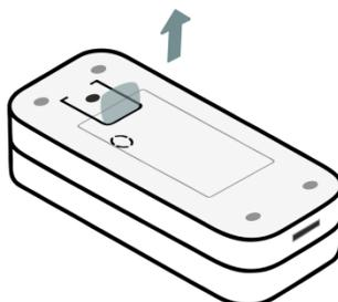
Рисунок 6.2 – Извлечение защитной пленки из датчика
