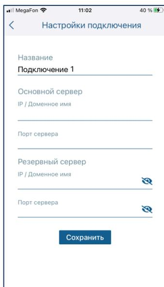
Рисунок 3.7 – Окно настроек подключения к серверу STEMAX<sup>3</sup>
