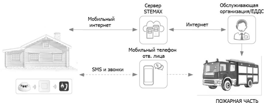
Помимо извещения о задымлении, комплект может передавать технические сообщения о состоянии входящих в него устройств: о разряде батарей, вскрытии корпуса и неисправности.
