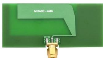
Малогабаритная приемно-передающая GSM-антенна
