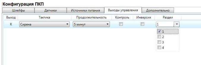
Рис.21 Настройка раздела для выхода управления
