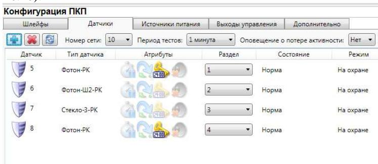
Рис.20 Настройка конфигурации разделов для радиодатчиков «Ладога-РК»
