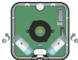
Рисунок 4.23 – Снятие защитных пленок с батарей сирены
