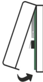
Рисунок 4.19 – Закрытие корпуса ретранслятора Livi RTRM
