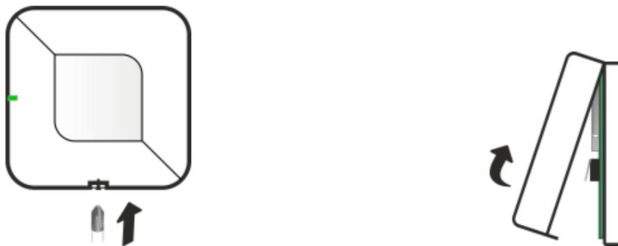
Рисунок 4.17 – Вскрытие корпуса ретранслятора Livi RTRM
