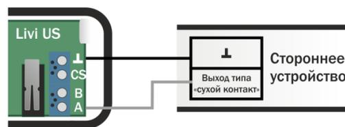
Рисунок 5.11 – Схема подключения одного устройства к датчику
