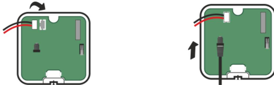
Рисунок 4.18 – Подключение питания к ретранслятору Livi RTRM
