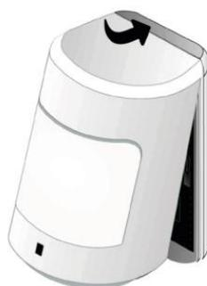
Рисунок 4.3 – Закрытие корпуса датчика движения
