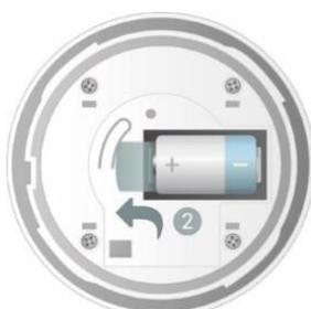
Рисунок 4.5 – Удаление защитной пленки
