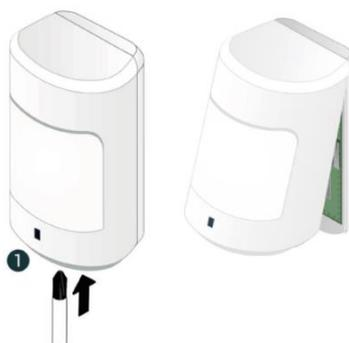
Рисунок 4.1 – Вскрытие корпуса датчика движения
