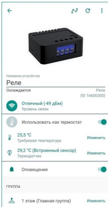
Рисунок 13.2 – Экран настройки реле
