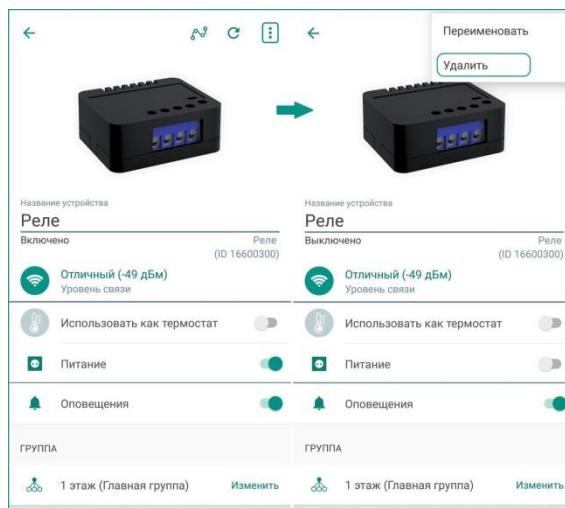
Рисунок 16.1 – Вызов меню на экране настройки реле
